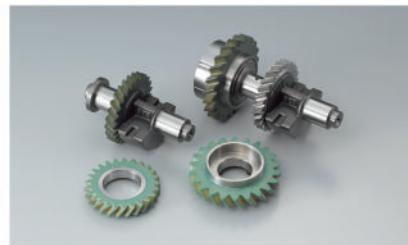
高強度樹脂ギヤは、アラミド系強化繊維を基材とし、高強度・高耐熱ポリアミド樹脂を注入硬化させた「コウベライトKM-9100」を歯切り加工したものです。従来のプラスチック製ギヤでは使用できなかつた過酷な負荷・環境条件下での使用が可能です。
