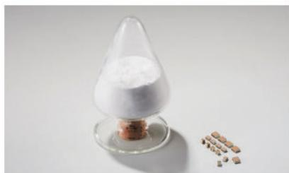
高純度酸化チタン「スーパータイタニア」は、身近な電子・電気機器に使用されるセラミックコンデンサーの主要原料です。
