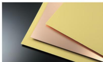
ガラスクロスにエポキシ樹脂を含浸させ、その両面に銅箔を貼り付けた材料です。高耐熱性、高弾性、低熱膨張などの特長を有し、プリント配線板や半導体パッケージ基板に使われています。
