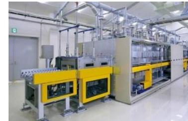
焼成炉/乾燥炉
