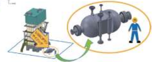
コンパクトリアクターイメージ 従来機の1/10程度までサイズダウンが可能
