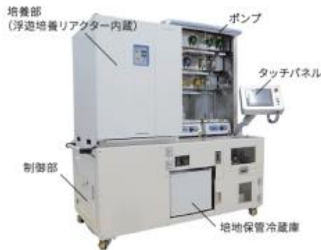
iPS細胞自動培養装置
